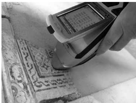
Analizador portátil de fluorescencia de rayos X (utilizado en el análisis de la moldura del Trono de Ntra. Sra. de las Angustias) analizando la pintura mural de un patio de la Alhambra
